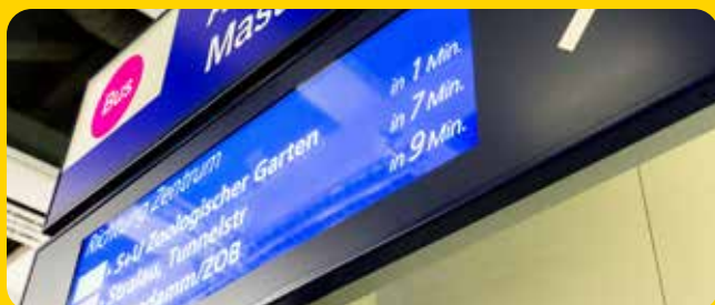
Prototyp für WLS-Integration: Echtzeitdaten-Voranzeiger in statisches Schild integriert.
